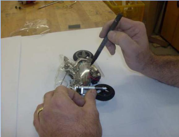
**Karosseriehälften auflegen und die Position für die M2er Bolzen und die Stützräder von außen markieren.**
